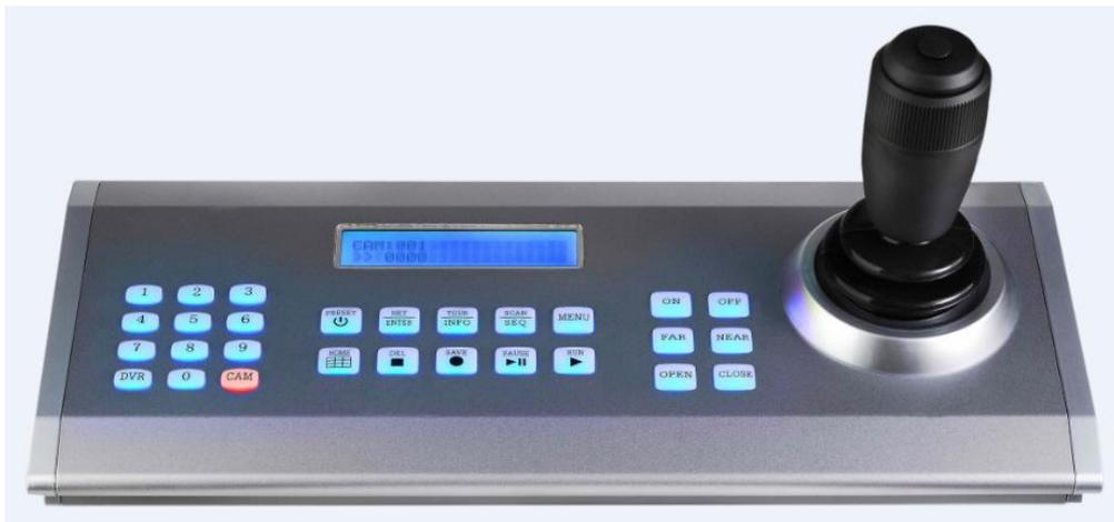
铝全金外壳，3轴光电式操纵杆，28个双色背光按键，适用于摄像机遥控、视频编辑，教育录播，视频会议系统等，免驱动。
