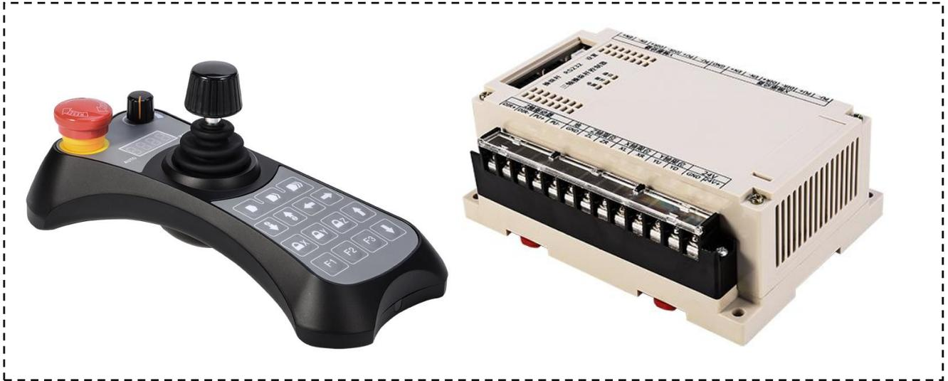
3轴控制器由 SMC72XL 操纵盒和 SMC30PLC 控制器组成，可以同时控制 3 套步进电机或伺服电机，用于平台的前后左右上下的控制；可适用于光学手动测量、激光焊接、机床设备、遥控机器人等行业；具有加减速、惯性、摇杆曲线速度变换等功能。
